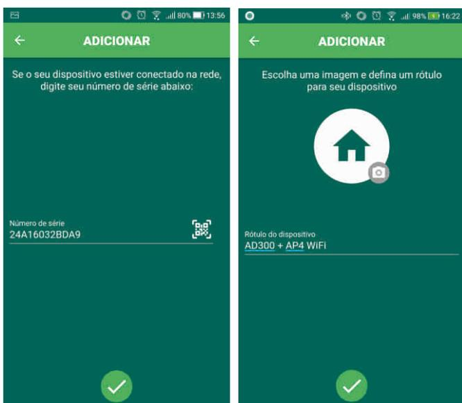
Ao configurar corretamente o dispositivo, o aplicativo exibe a tela com o número de série para cadastrar o módulo. Após, é possível nomear e escolher uma imagem para o seu dispositivo. Finalizado este procedimento, o módulo será exibido em sua lista de dispositivos, estando disponível para operação e configurações.
