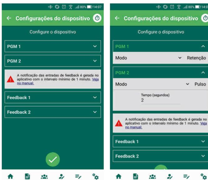
Nas configurações do dispositivo
